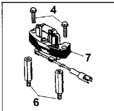
3. Die Zwischenstücke einschrauben und den Wechselstromgenerator mit den 6 kt.- Schrauben montieren. Spaltmaß auf 0,30 mm einstellen.
