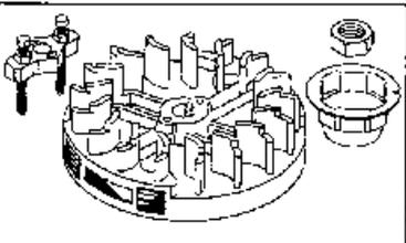
4. Schwungradmutter abnehmen und Schwungrad mit Abzieher lösen.
