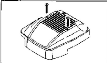
1. Lösen der beiden Kreuzschlitzschrauben und Abdeckhaube abnehmen.
