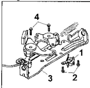
1. Schalter mit den 6 kt.-Schrauben an der neuen Bremse befestigen und kpl. Bremse mit den 6 kt.-Schrauben anbauen. Kurzschlußkabel und Bowdenzug einhängen.
