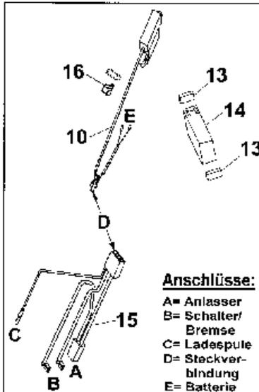
6. Die Moosgummis auf die Batterie kleben, Batterie einsetzen und am Kabelbaum anschließen. Die restlichen Anschlüsse gem Abbildung vornehmen. Die neue Schelle mit Schlaufe anbringen.
