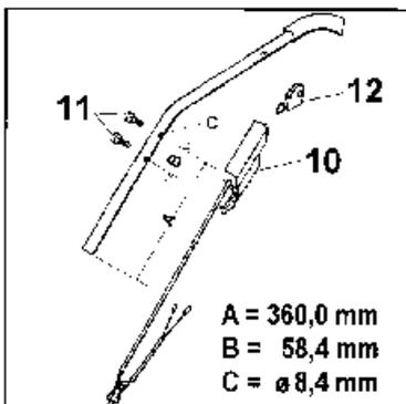
5. Am Griffoberteil rechts 2 Bohrungen  $\varnothing$  8,4 mm anbringen und das Startergehäuse kpl. mit den 6 kt.-Schrauben befestigen.
