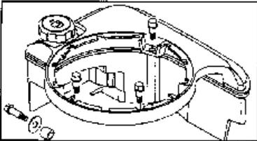
2. Lösen der vier 6 kt.-Schrauben und Tank kpl. zur Seite legen (Der Benzinschlauch muss zu diesem Zweck nicht abgeklemmt werden).
