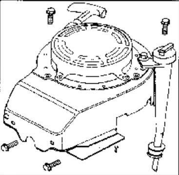
3. Lösen der fünf 6 kt.-Schrauben und Lüfterhaube mit Starter und Öleinfüllrohr abnehmen
