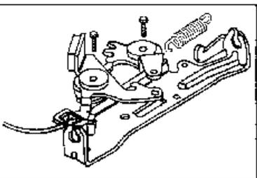
5. Lösen der zwei 6 kt.-Schrauben und Bremse abnehmen, Kurzschlußkabel und Bremsbowdenzug aushängen.
