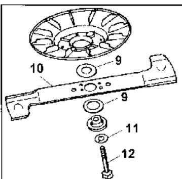
3. Schneidwerk montieren (Mit = 38-42 Nm).
