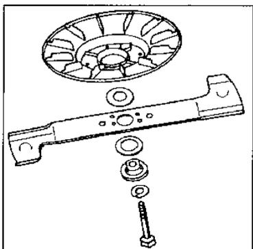
2. Messerbalken und Lüfterrad demontieren.
