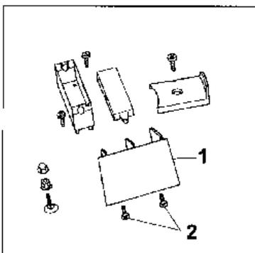
1. Neue Kanaleinlage in das Chassis einbauen. Keilriemenabdeckung und Batteriekasten, sowie Flachrundschraube mit Mutter und Verschlusskappe befestigen.
