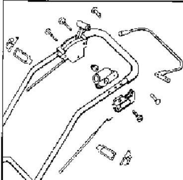
1. Bowdenzug (Motorbremse) aushängen. Oeco-Schaltgehäuse, Bremshebel und Stütze demontieren. Klammern und Schläufen entfernen.
