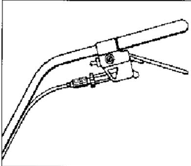
1. Kontermutter am Kupplungsbowdenzug lösen und Einstellschraube bis zum Anschlag nach rechts drehen.
