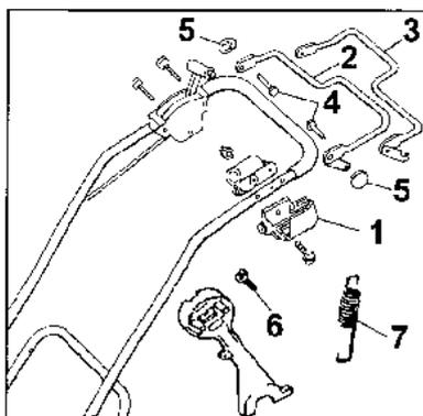
1. Neue Stütze, neuen Brems-, neuer Kupplungshebel und Oecoschaltgehäuse montieren. SF-Schraube M5x20 in die Kanone am Griffhalter links einschrauben und Zugfeder mit dem kurzen Haken einhängen.
