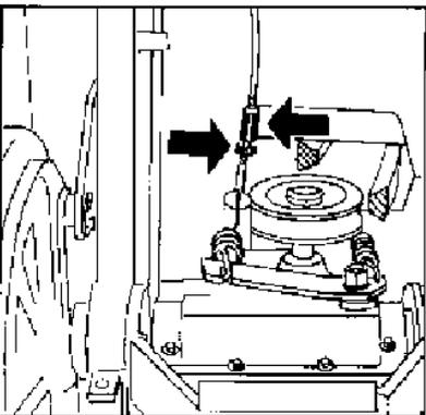
3. Kupplungsbowdenzug am Getriebe so einstellen, dass die Antriebsräder beim Rückwärtsziehen des Mähers blockieren.
