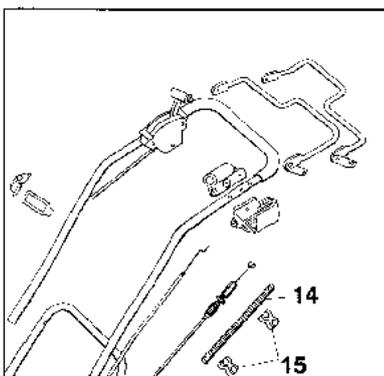
3. Bowdenzüge durch den Wellschlauch führen. Bremsbowdenzug am Bremshebel einhängen. Kupplungsbowdenzug mit dem 6-kant in die Stütze führen und am Kupplungshebel einhängen. Neue Klemmen an Ober- u. Untergriff anbringen.
